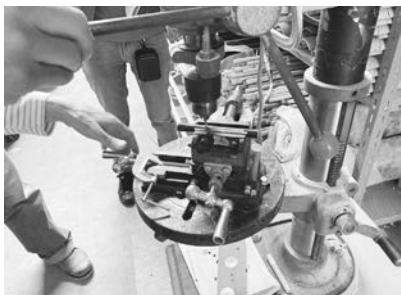
①柄の竹に穴をあけ 木ハジキの幅に穴を広げる
