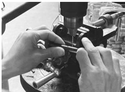
④柄にハジキをはめて 軸の穴をあけ、竹を挿しこむ
