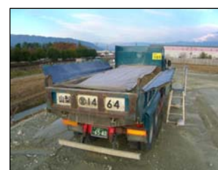
・車両の出入り口や周辺道路の清掃及び散水、タイヤの洗浄 ・荷台への防塵シート敷設及び散水
