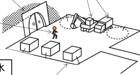
・工事排水の適切な処理 ・工事排水の監視 ・放流時の放流箇所及び水温の調整
